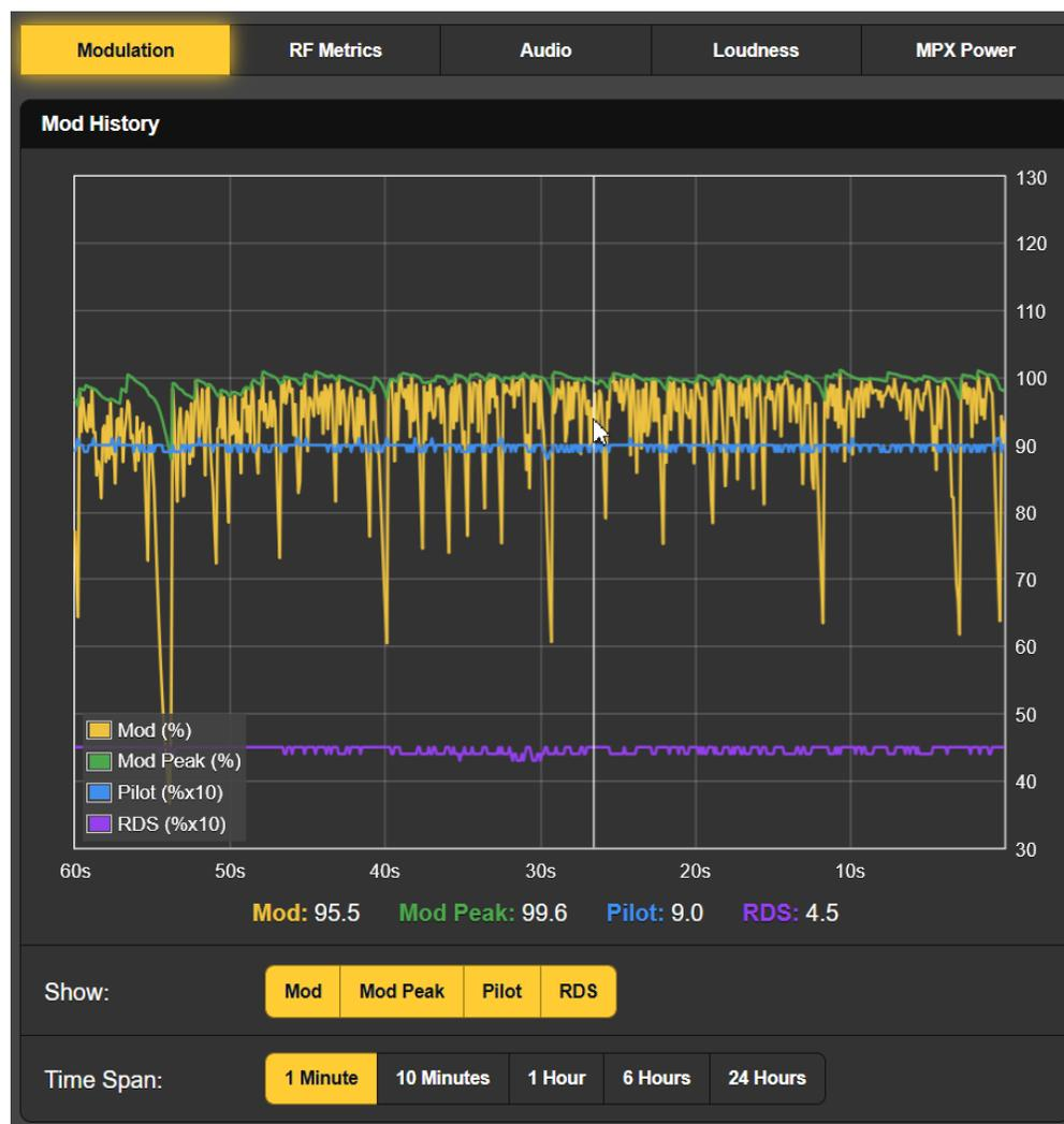
Observe los botones Show: debajo de la pantalla. Cuando todos los botones están activados (por defecto como en la imagen), los cuatro parámetros se muestran arriba en diferentes colores. Si una visualización en particular le resulta confusa, puede desactivar fácilmente las mediciones que no necesite ver.
