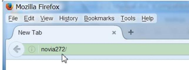
Bajo el sistema operativo Windows®, simplemente acceda al NOVIA 272 con un navegador de Web que se encuentre en la misma red, escribiendo el Hostname y una barra diagonal en la barra de direccionamiento del navegador, como se muestra aquí. En los navegadores que no estén bajo Windows se requerirá introducir toda la dirección IP de la unidad.
