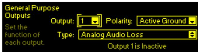
tive Ground (el terminal va a tierra con una alarma) o Active Open (el terminal normalmente está a tierra y se abre con una alarma). Type: se puede asignar a Analog Audio Loss, Digital Audio Loss o Stream Audio Loss. None inhibe la apertura o cierre en el terminal de alarma. Los parámetros de programación de las alarmas son explicados a partir de la Página 10.
