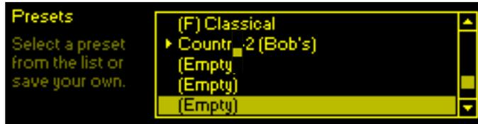
Crear un pre-ajuste es fácil. Después de haber entonado el sonido adecuado para su estación, desplácese hasta el principio del menú Presets para hacer Save Preset. Presione el botón y, como será indicado, Name Your Preset [asígnele un nombre a su pre-ajuste]. Finalice con un Save. Verá el Nuevo pre-ajuste al final de la lista.
