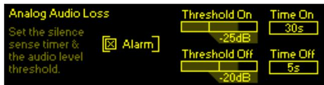
Threshold On es el nivel de audio debajo del cual debe bajar el programa para activar una alarma. Es más, el nivel de audio debe permanecer por debajo de este punto el número de segundos programados en la casilla Time On. Del mismo modo, Threshold Off es el nivel de audio al que el programa debe retornar y permanecer por encima por el tiempo en segundos de Time Off, para restaurar la alarma.
