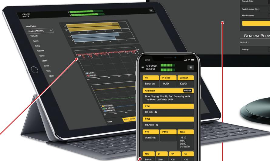
Una pantalla de nivel de audio de alta resolución está acoplada a un histograma rodante de la dinámica del programa para una representación de la densidad de la modulación (sonoridad) a lo largo del tiempo. La métrica de la señal FM se captura durante el mismo período de tiempo, y la pantalla gráfica puede mostrar el último minuto, 10 minutos, 1 hora, 6 horas o 24 horas.
