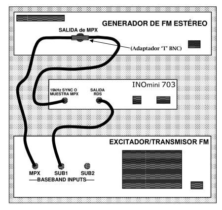
El conector 19kHz SYNC o MPX SAMPLE del 703 *debe* puentear la señal de salida compuesta del generador de estéreo para sincronizar y enganchar la fase del RDS a los 19kHz del piloto de estéreo.
