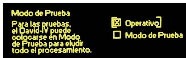
En "Prueba", los controles de nivel de entrada y salida siguen siendo funcionales, pero todos los utilitarios de dinámicas de procesamiento se fijan en ganancia unitaria con una característica de frecuencia plana [flat].
