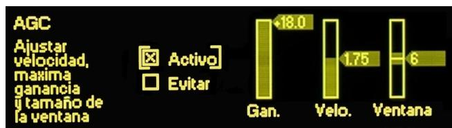
Antes de ajustar la ganancia de entrada del DAVID IV bajo el subtítulo anterior, el AGC se confirmó en la configuración por defecto de fábrica; es decir, con el AGC activado durante todo el rango de corrección de  $\pm 18$  dB con valores medios para la tasa de corrección y la 'ventana'. En realidad, estos ajustes deben trabajar bastante bien para casi cualquier formato de emisión, pero puede haber casos en los que podrían querer ser cambiado.
