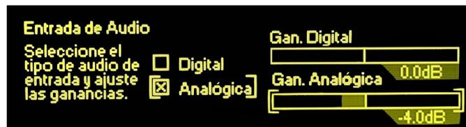
A continuación, *gire* la perilla selectora hasta posicionar los corchetes alrededor del deslizador Ganancia Digital Gain o Ganacia Analógica, cualquiera sea la selección que haya escogido. *Pulse* la perilla selectora para activar al selector para luego *girar* la perilla e introducir la ganancia requerida.
