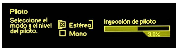
Aquí el DAVID IV se puede colocar en modo  Mono (transmisión monoaural) para prueba o para circunstancias especiales, aunque  Estéreo será la elección habitual para la operación normal. Seleccionando  Mono elimina el tono piloto estéreo de 19 kHz y la subportadora S' (I-D "diferencia estéreo"). La salida de sincronización de 19kHz RDS permanece activa, independientemente, asegura que los mensajes RDS siguen siendo una opción disponible en mono.
