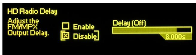
El retardo de Radio HD puede ser configurado en incrementos de 1mseg, en cualquier valor entre 1mseg y 9,999seg. Esto es un rango mayor del requerido, pero expresa la esperanza en mejoras en el proceso de codificación/decodificación del sistema de HD Radio.
