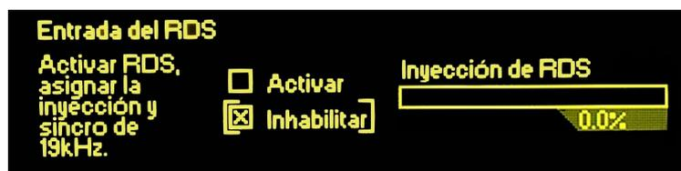
Antes de conectar el codificador RDS, primero asegúrese de bajar el deslizador de inyección RDS hasta el final. *Gire* la perilla selectora para poner entre corchetes el control deslizable, *pulse* la perilla para seleccionarlo y, a continuación, *gire* la perilla en sentido anti horario hasta que la parte iluminada de la corredera está fuera de la parte inferior de la escala. Tenga en cuenta que los números debajo de la corredera no cambian durante esta operación.
