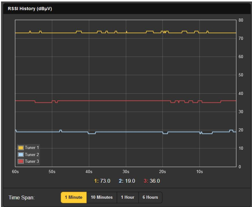
La señal más fuerte que se muestra aquí, el trazo amarillo superior, es la estación AM del Punto de Entrada Primario (PEP) que se está monitoreando para detectar alarmas EAS. La traza roja central es la propia estación de FM del usuario, monitoreada principalmente como indicador de confianza. La lamentable traza azul hacia abajo es la estación meteorológica NOAA más potente que se puede recibir en este mercado.
